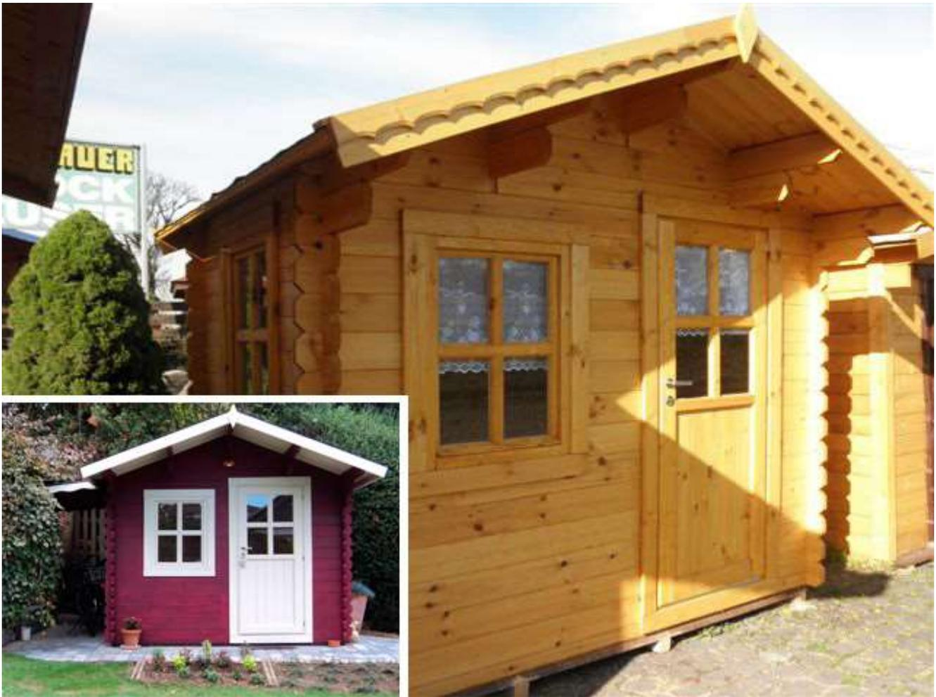
**Bohlenstärke 34 mm mit doppelter Nut+Feder aus nordischer Kiefer, mit ~20 mm Fußbodendielen, Vordach vorne ca. 60 cm, Dachbretter ~19 mm auf Sparren, inkl. allen Beschlägen, stabile halbverglaste Tür mit Schloss und Drückergarnitur, Fenstergröße bei 300 cm Hausbreite 88/88 cm mit massiven Sprossen und DK-Beschlag, Premiumverglasung (4/16/4 mm)**
